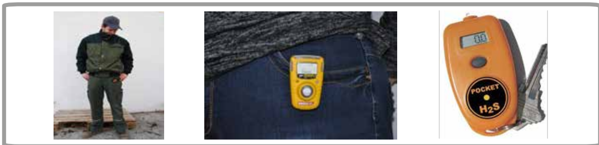
Ovenstående fotos viser forskellige typer af gasdetektorer. Detektorerne kan bæres på forskellig vis – enten fastgjort på tøjet, i en nøglering, i hånden eller om halsen i en snor.
