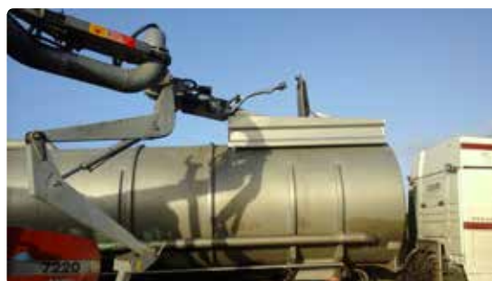
Monteret kamera til overvågning af gylleopfyldning i tanktrailer.
